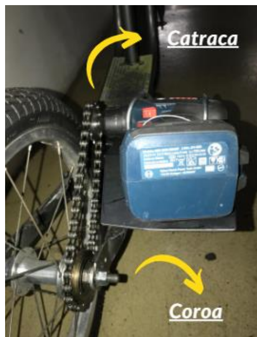
Figura 10 - Sistema de transmissão do patinete. Fonte: Autores
