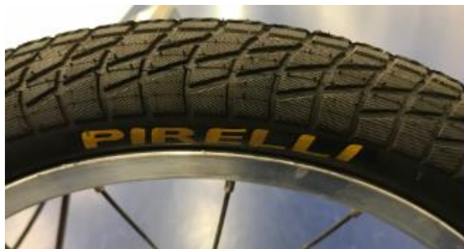
Figura 16 - Pneus Pirelli Semi Slick. Fonte: Autores
