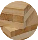
Madeira Laminada Cruzada (CLT) para a estrutura
