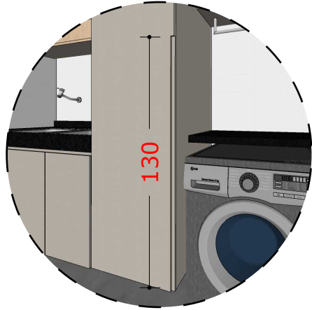
DETALHE 03 - CAVA VERTICAL ESCALA 1/5
