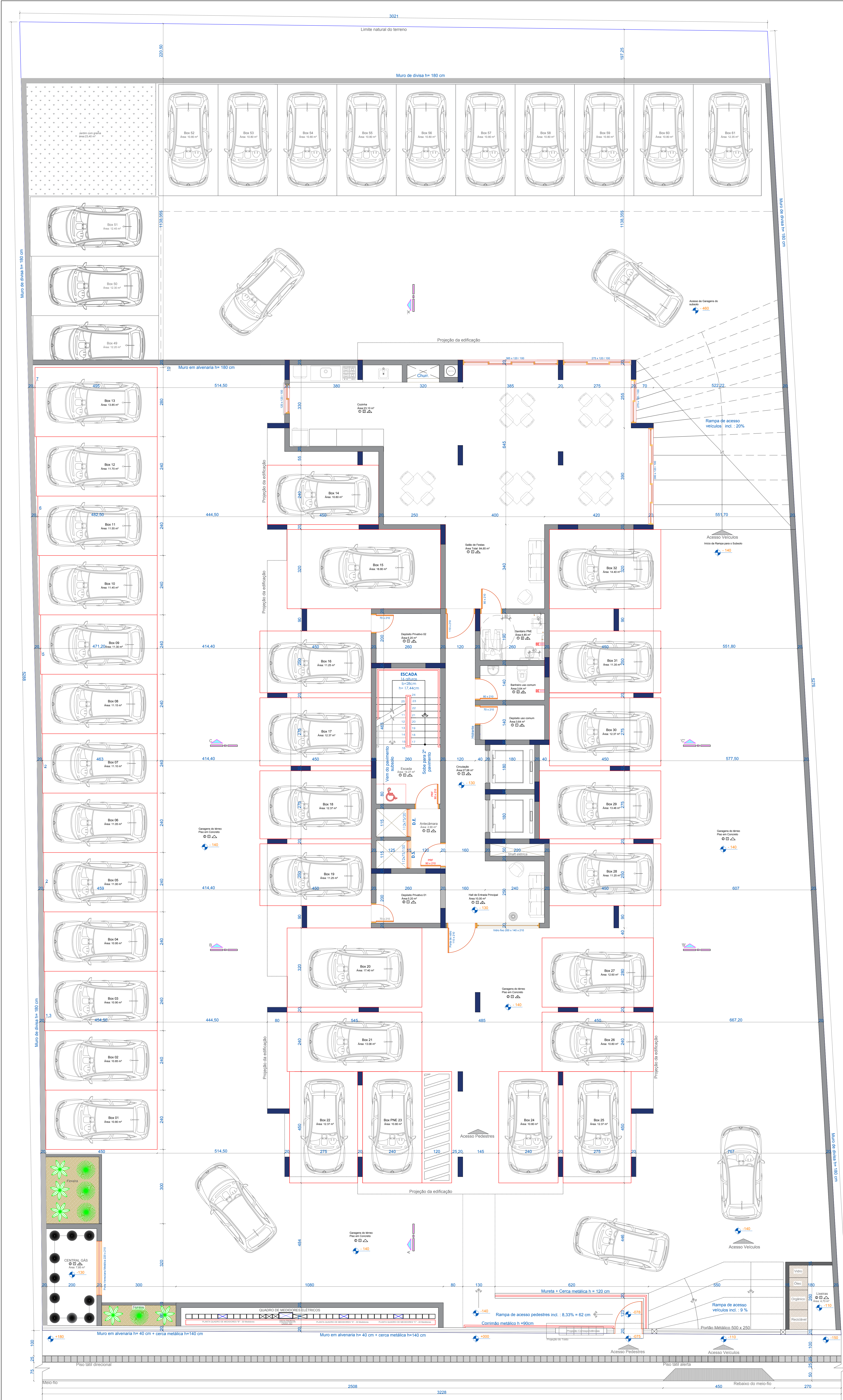
Planta Baixa Pavimento Térreo ( 32 vagas de garagens) Área não computável = 1.163,50 m² Área Total = 1.163,50 m²
