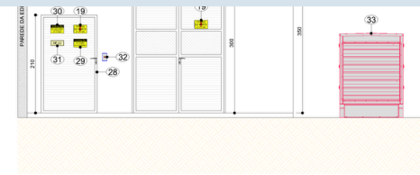
FACHADA 5 SUBESTAÇÃO DE TRANSFORMAÇÃO - SE-02 ESCALA: 1:50
