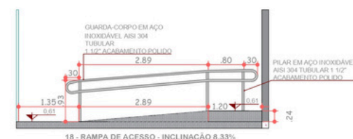
04 CORTE RAMPA PCD 02 ESCALA.....1:50
