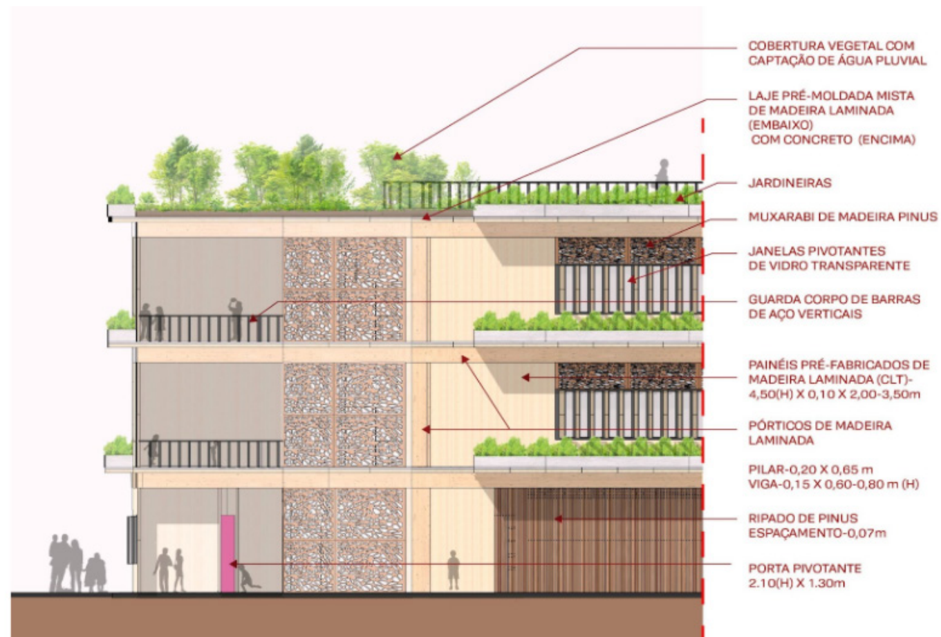
VISTA ESQUEMÁTICA DOS COMPONENTES DA EDIFICAÇÃO
