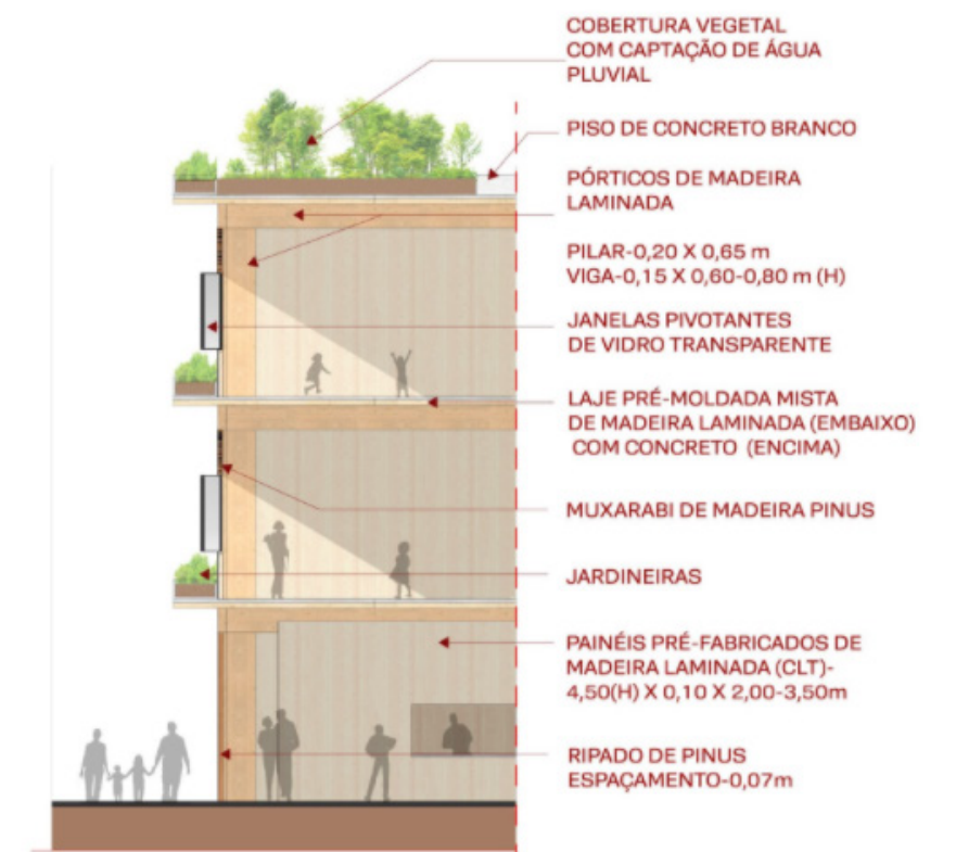
CORTE ESQUEMÁTICO DOS COMPONENTES DA EDIFICAÇÃO
